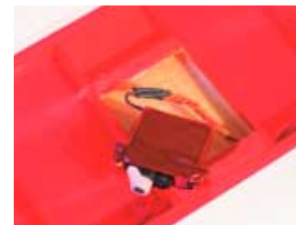
Eines der vier Servos – fertig verlötet, eingeschrumpft und zum Einharzen vorbereitet
