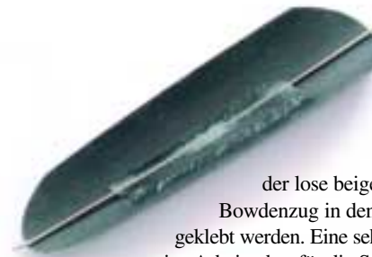
2-Millimeter-Federstahldraht, Glasgewebe und etwas Zweikomponentenharz sind ausreichend zur sicheren Befestigung der Kabinenhaube
