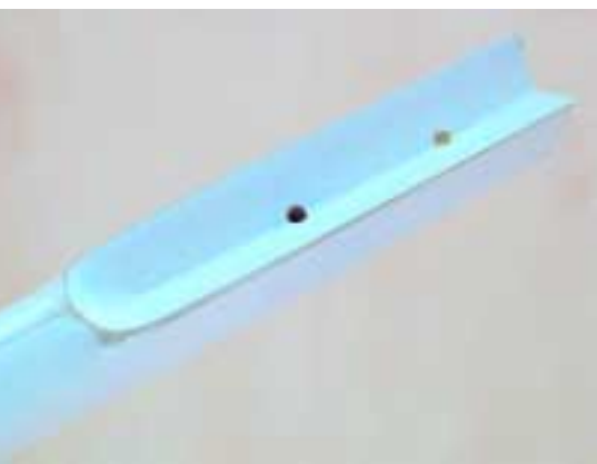
Der fertig angeformte Leitwerksträger mit 110 Grad, inklusive Gewinde für M4-Polyamidschraube
