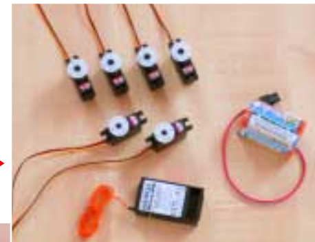
Vier Stück HS81-MG für Wölbklappen und Querruder und zwei HS81 für das V-Leitwerk
