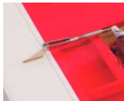
Anlenkung mittels beigefügten GFK-Ruderhörnern
