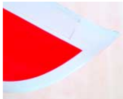
Die Folie wurde exakt und parallel auch am Randbogen aufgebracht
