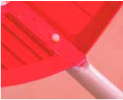
▲ Der wirklich einzige Kritikpunkt am gesamten Bausatz ist die Passgenauigkeit zwischen Träger und Leitwerk
