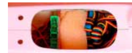
Gut zugänglich sind die Stecker zur Versorgung der Flügelservos unter dem Flügel
