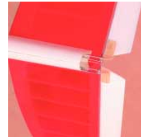
Die Anlenkung der V-Leitwerksruder mittels Gabelkopf und GFK-Ruderhörner aus dem Kleinteilesatz
